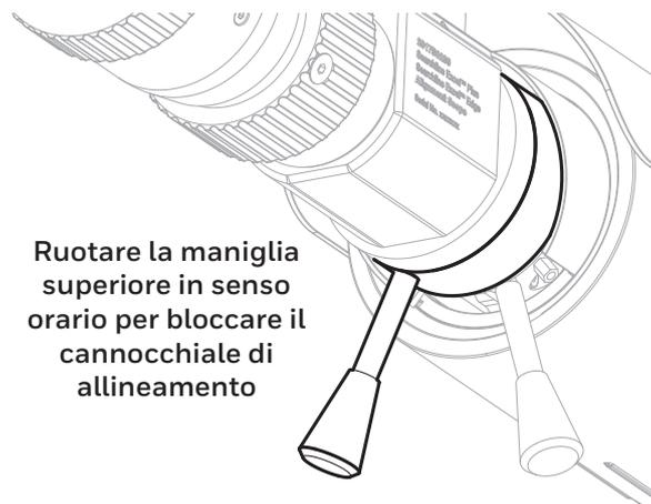
Figura 35. Blocco del cannocchiale di allineamento
